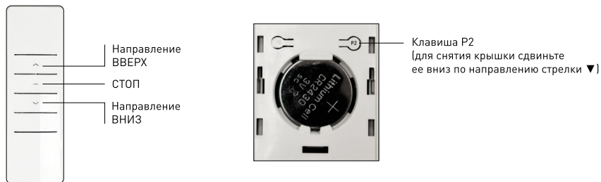
Рис. 7. Пульт управления карнизом для штор
