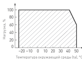
Рис. 2. Максимальная допустимая нагрузка, % от мощности источника
