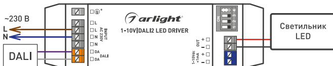
Рис. 1. Подключение источника тока при использовании интерфейса DALI
