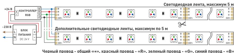
Черный провод - общий «+», красный провод - «R», зеленый провод - «G», синий провод - «B»
