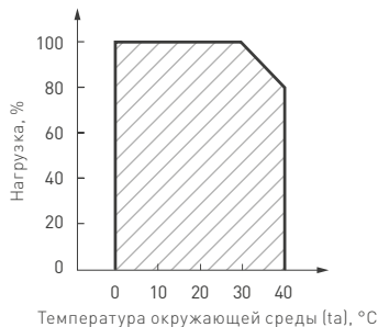
Рис. 2. Максимальная допустимая нагрузка, % от мощности источника.
